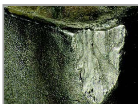
Rottura da incollamento truciolo
